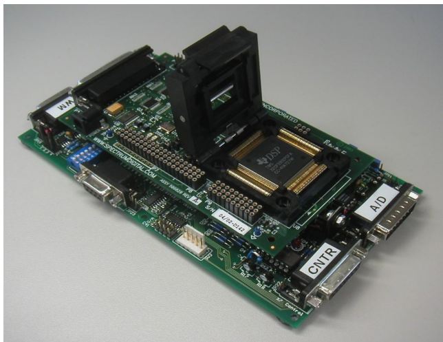
Obr. 8 Řídicí systém se signálovým procesorem TMS 320F2812
